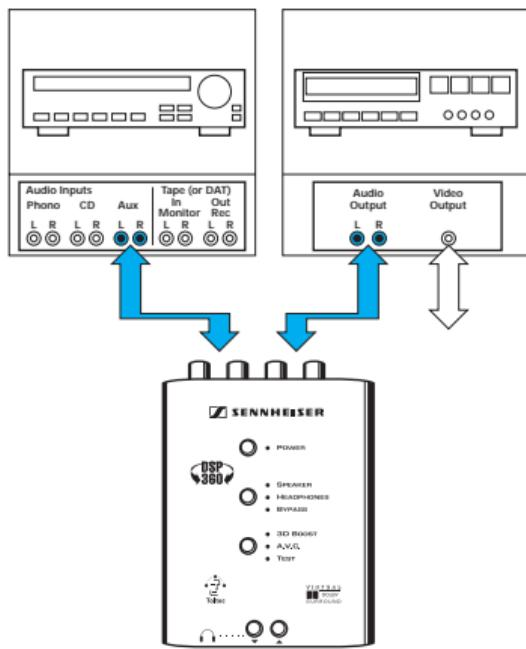
Così facendo avrete la possibilità di controllare e regolare il segnale audio del vostro televisore attraverso il processore DSP dal vostro ricevitore.
